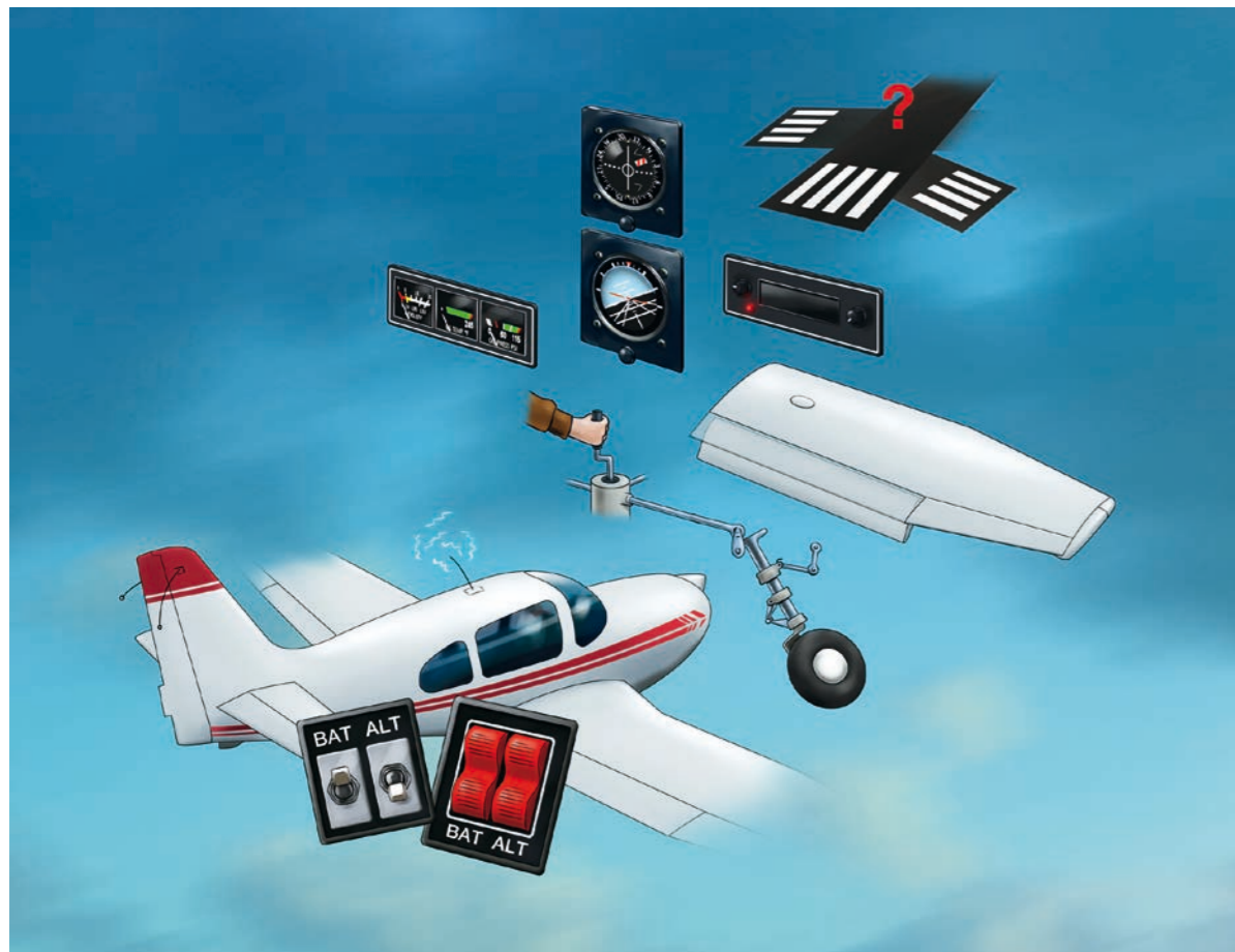
Was wenn? Systemkenntnis hilft, Fehlfunktionen zu verstehen und die richtigen Maßnahmen zu ergreifen – etwa den Alternator anzuschalten, damit die Batterie nicht entladen wird
